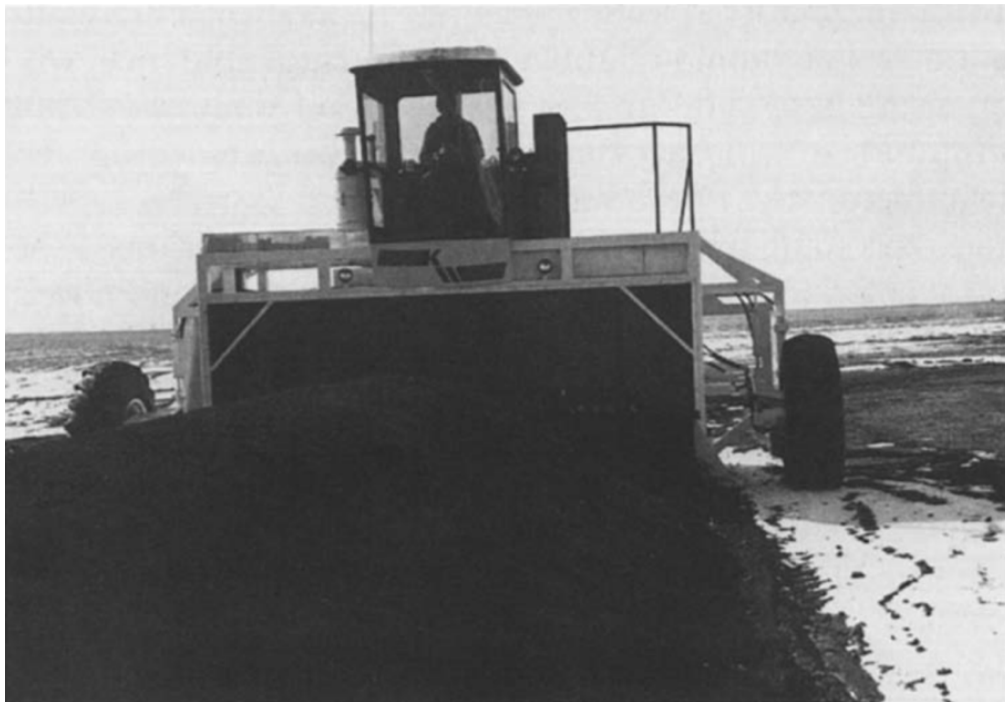
Figura 3.5 - Máquina especializada em revolver leiras de compostagem com capacidade de aerar 2000 toneladas de resíduos por hora.
