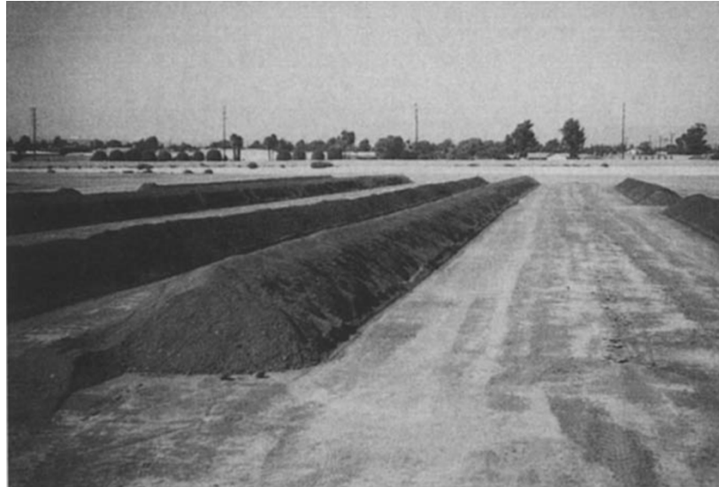
Figura 3.6 - Local de compostagem de lodo de esgoto, mostrando leiras perto da finalização do processo.
