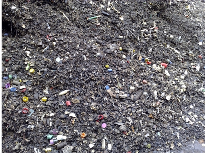
Figura 5.15 - Composto de lixo orgânico proveniente da UTMB de Ceilândia. CORS descartado por apresentar alto nível de contaminação por materiais inertes.
