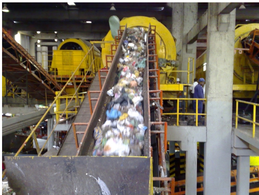
Figura 5.13 - Condução dos resíduos em esteiras até a Peneira Trommel (rotativa)
