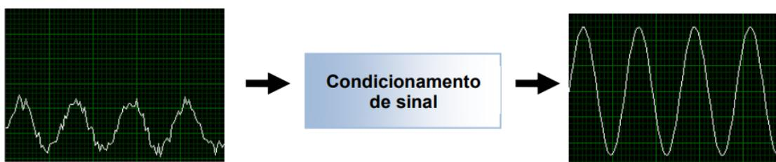
Figura 19 – Condicionamento de sinal. Aplicação de filtro e ganho (Serrano, et al. (2004)).
