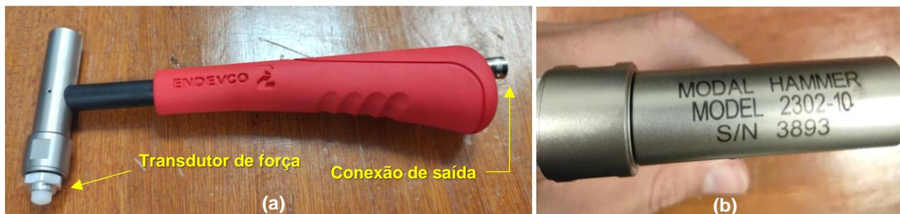
Figura 90 – (a) Martelo de impacto instrumentado. (b) Vista superior do martelo com número de série e modelo.
