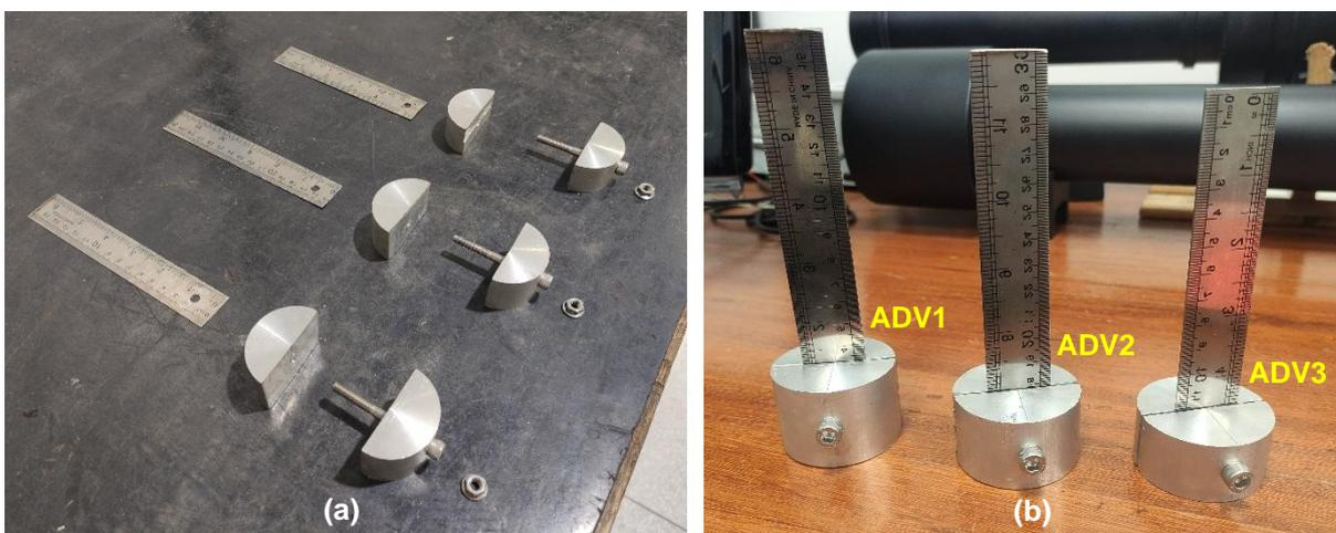
Figura 79 – Etapa 5 da montagem. (a) Conjuntos para montagem dos ADVs. (b) ADVs finalizados.
