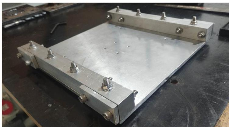
Figura 75 – Etapa 3 parcialmente completa. Placa M1 com superfície inferior voltada para cima.
