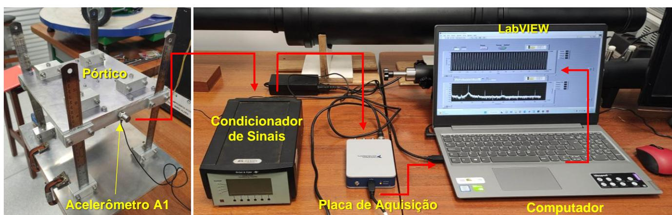
Figura 86 – Cadeia de instrumentação para vibração livre.
