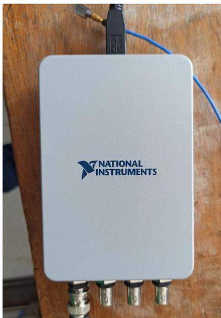
Figura 20 – Placa de aquisição de dados.
