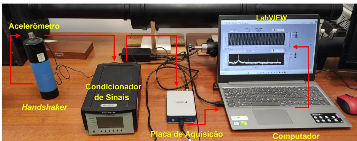
Figura 84 – Cadeira de instrumentação para calibração dos acelerômetros.
