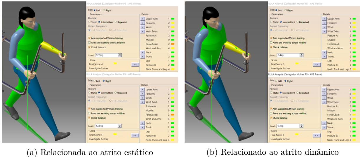
Figura 55 – Análise RULA da carregadora mulher P5 para cadeira configurada para o seu percentil, autores
