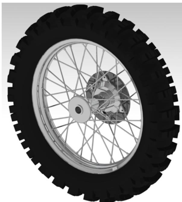
Figura 33 – Conjunto roda R14 pneu 90/100 49M, autores
