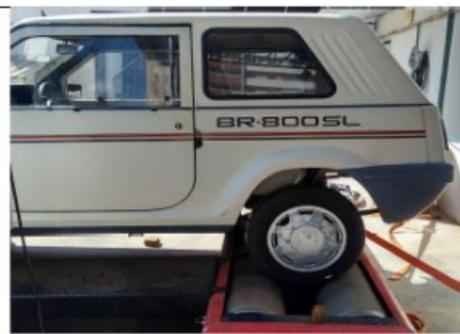
Figure 2 - Veículo montado no Dinamômetro
