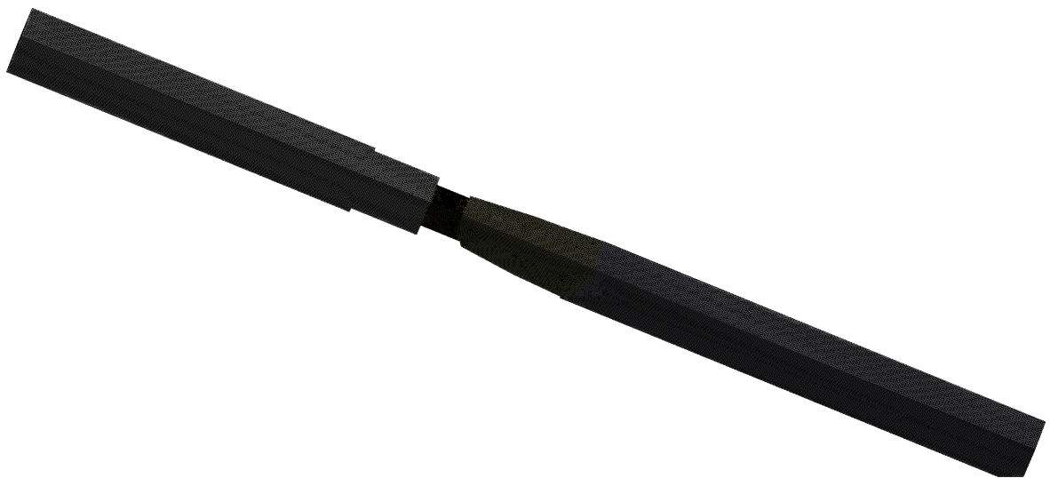
Figura 23 – Malha para as simulações de válvula aberta n° nós=873011
