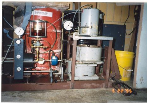
Figura 3.10 - Máquina para ensaio de cisalhamento direto de 0.3m de diâmetro (Edinçliler et al. 1996)
