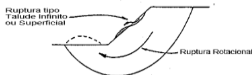
a. Ruptura da Base e Talude
