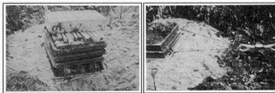
Figura 3.12 - Cisalhamento direto em RSU in-situ (Withiam et al. 1995, apud Edinçliler et al. 1996)
