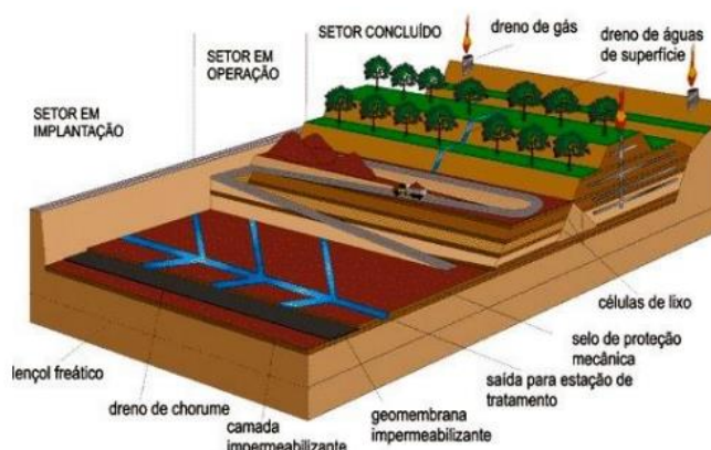
Figura 3.1 - Diagrama esquemático de um aterro sanitário (Fonte: IPT/CEMPRE, 2000)
