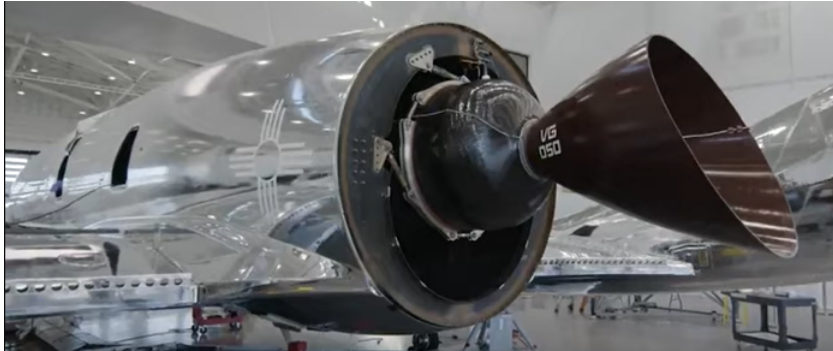
Figura 1 – Método de fixação do RocketMotorTwo à fuselagem da SpaceShipTwo (MECHDESIGNTV, 2020).
