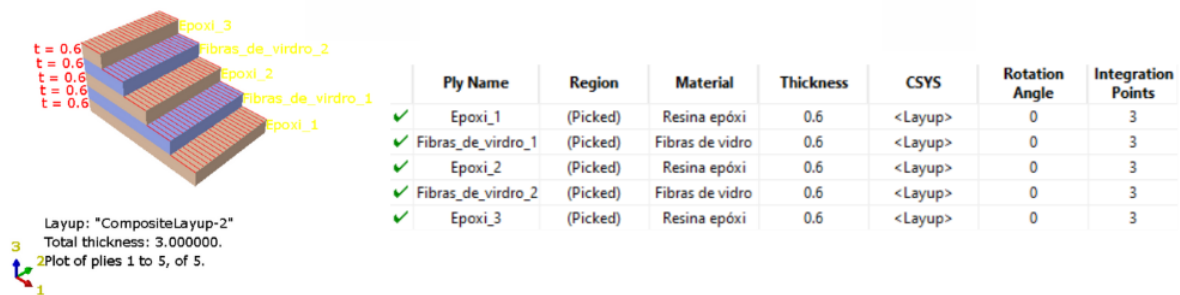
Figura 24 – Configuração das camadas do compósito sintético.
