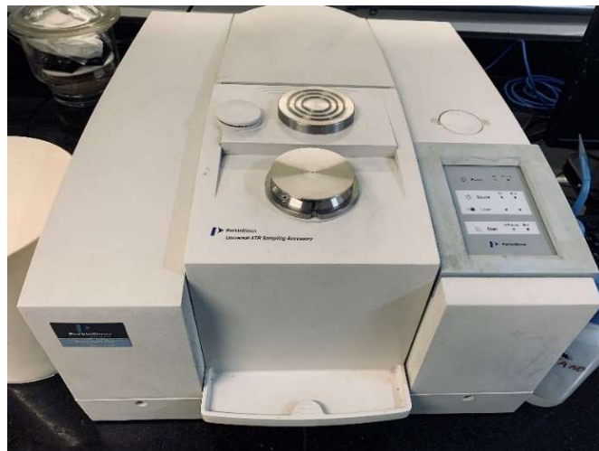
Figura 6. Espectrômetro de absorção no infravermelho Spectrum One da Perkin Elmer.
