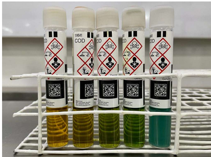
Figura 23. Coloração das cubetas contendo o branco seguido das quatro amostras diluídas, em ordem crescente de volume de amostra diluída, da esquerda para a direita.
