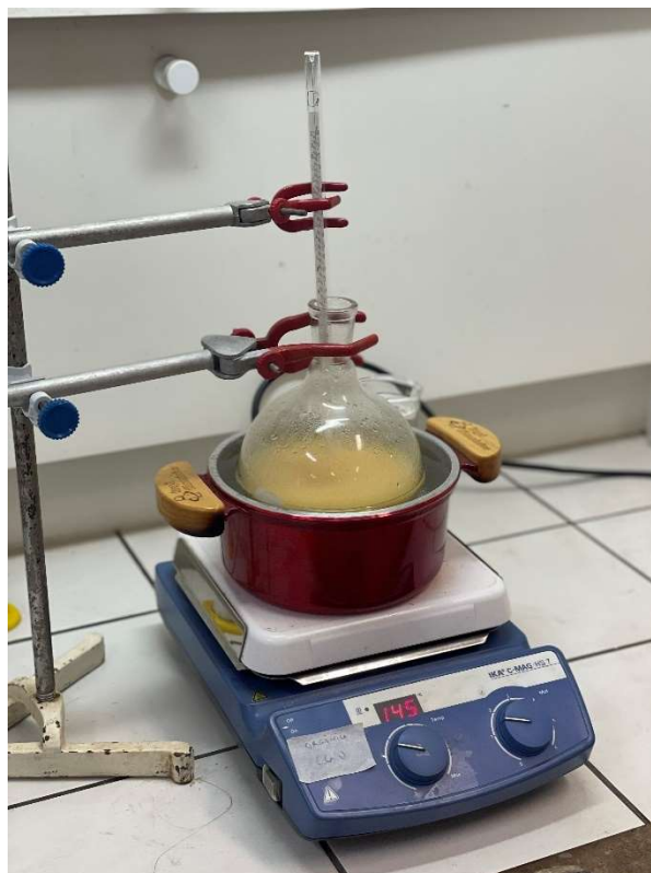
Figura 32. Esquema preparado para a síntese do epóxido 1 e diol 1, sem refluxo.
