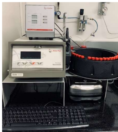
Figura 3. Viscosímetro utilizado da marca Anton Paar modelo Stabinger SVM 3000.
