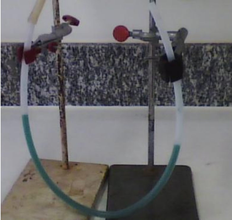
Figura 1: Manômetro confeccionado com mangueira de aquário com líquido composto de água e corante.
