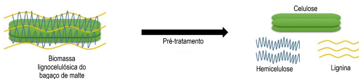
Figura 7: Esquema do pré-tratamento da biomassa lignocelulósica. Fonte: Adaptada de “Valorization of Brewers’ Spent Grains: Pretreatments and Fermentation, a Review” (MITRI et al. , 2022)
