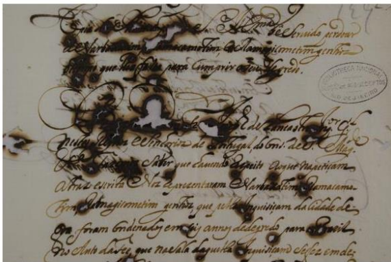
FIGURA 13: Corrosão ferrogálica em manuscritos históricos demonstrada pela presença de manchas marrons e buracos.
