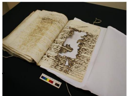
FIGURA 13: Corrosão ferrogálica em manuscritos históricos demonstrada pela presença de manchas marrons e buracos.
