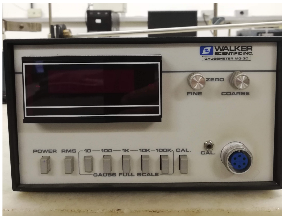
Figura 49 – Guassímetro utilizado para medir o campo magnético
