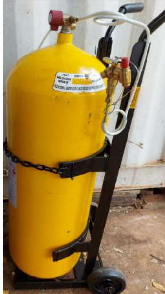
Figura 10 – Cilindro contendo gás natural veicular (GNV), instalado na parte externa do laboratório Fonte: Próprio autor
