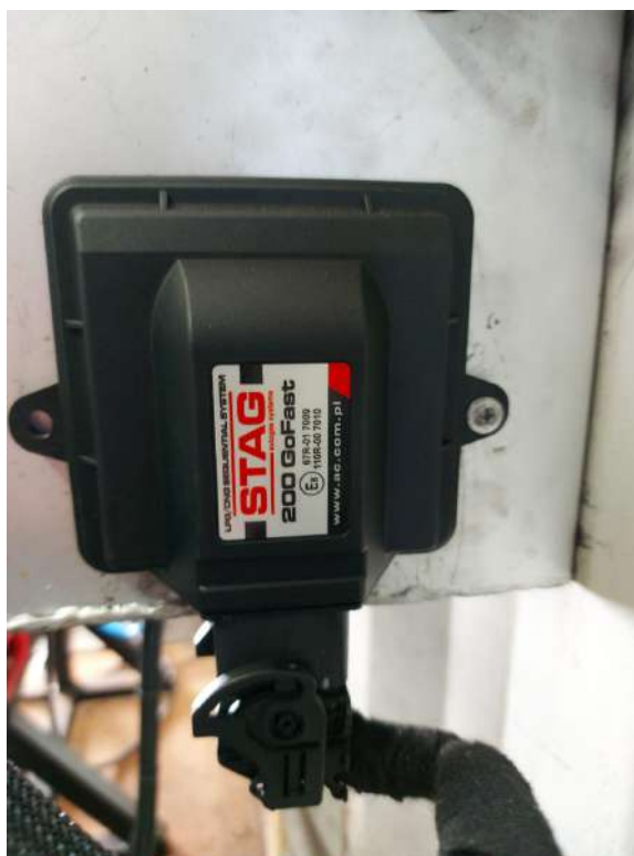
Figura 17 – Unidade de controle eletrônico do "Kit Gás". Fonte: Próprio autor
