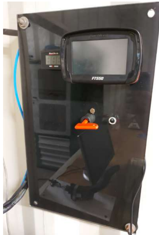
Figura 46 – Painel com ECU FT modelo 550, da marca FuelTech , instalada no laboratório. Fonte: Próprio autor
