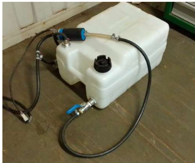
Figura 9 – Tanque de combustível contendo etanol hidratado, utilizado para ensaio de desempenho de motor. Fonte: Próprio autor
