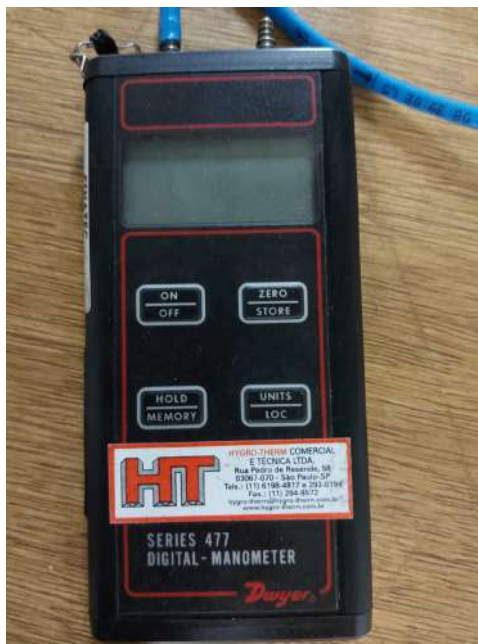
Figura 19 – Manômetro utilizado para medição da pressão do ar na placa de orifício. Fonte: Próprio autor
