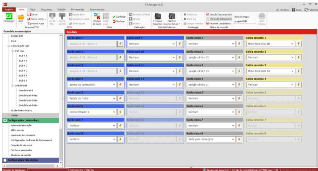
Figura 48 – Configurações dos sensores e valores de saída, do motor para ECU, gerado pelo ambiente FT Manager. Fonte: Próprio autor
