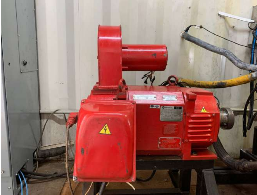
Figura 18 – Dinamômetro axial pronto para conexão ao motor em teste, no laboratório "LEM". Fonte: Próprio autor
