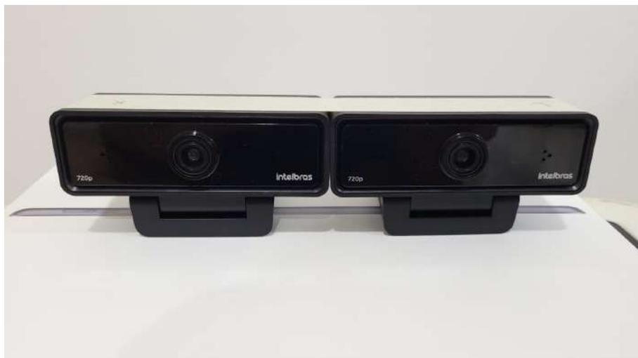
Figura 43 – Sistema de visão estéreo implementado.
