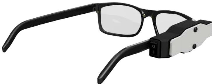
Figura 83 – Modelagem do suporte laser modelo óculos. Vista isométrica.
