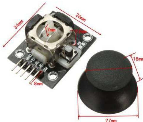
Figura 38 – Dimensões do joystick.
