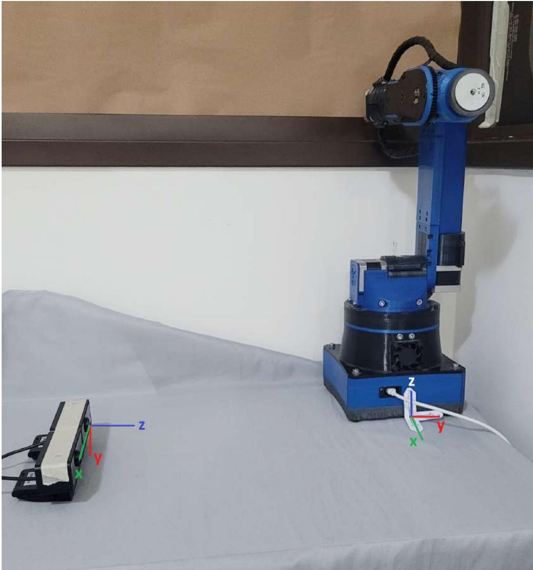
Figura 80 – Indicação dos sistemas de coordenadas da câmera e do robô.
