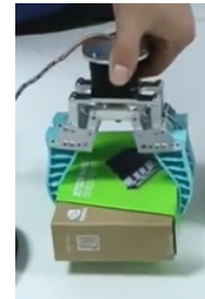
Figura 43 – Garra adaptativa segurando uma caixa (MOEBIUSTECH, 2017)
