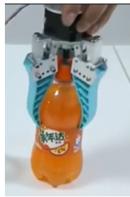
Figura 42 – Garra adaptativa segurando uma garrafa de plástico (MOEBIUSTECH, 2017)
