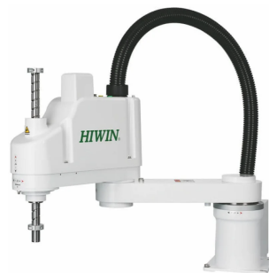
Figura 47 – Configuração clássica do robô SCARA (MECTROL, 2022)
