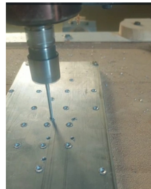
Figura 53 – Furação da base de elevação
