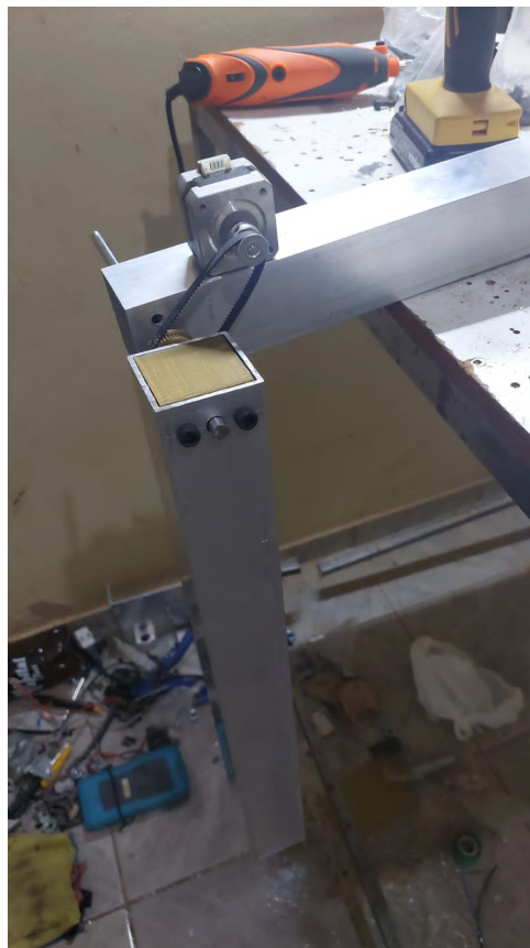
Figura 61 – Montagem da redução do segundo elo
