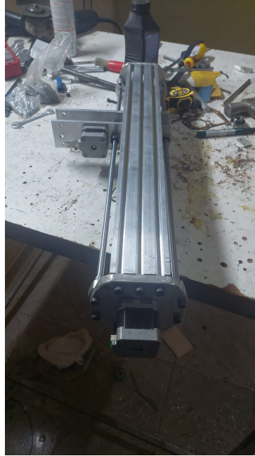
Figura 54 – Base de elevação montada
