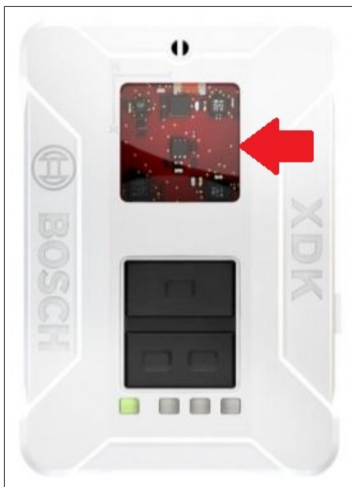
Figura 3.4: Posição do sensor de Luz Ambiente - MAX44009, sob o acrílico no kit da Bosch [1].
