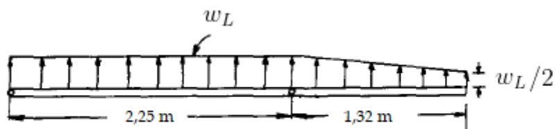
Figura 34 – Distribuição de sustentação em uma asa
