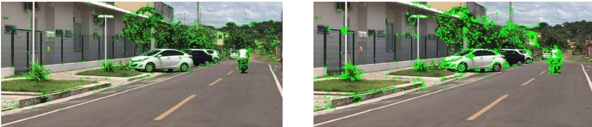
(a) Detecção de cantos com supressão não máxima ativada para uma imagem 800x360
