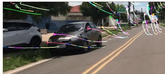
(b) Fluxo óptico esparsos utilizando o detector de cantos Shi-Tomasi e rastreador de features iterativo Lucas-Kanade
