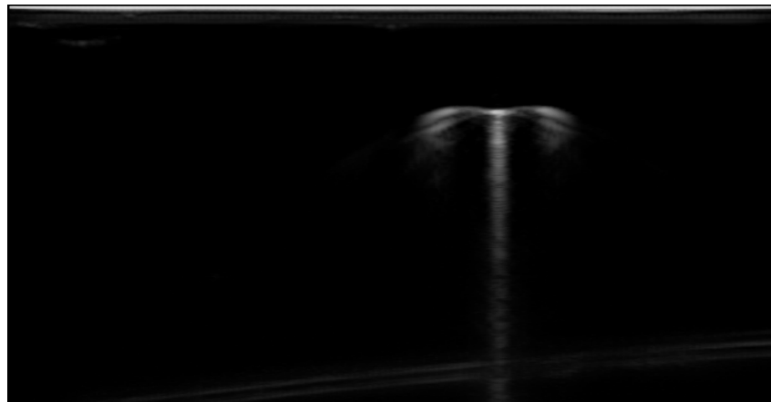
Figura 10 – Representação ecográfica de uma agulha flexível imersa em banho d'água, contendo uma cauda de cometa formada por artefatos de reverberação.
