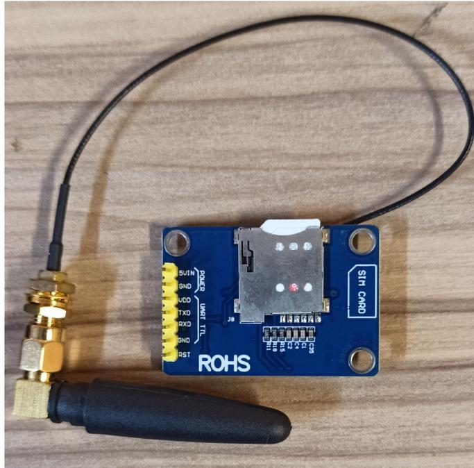
Figura 7 – Módulo SIM800L utilizado.
