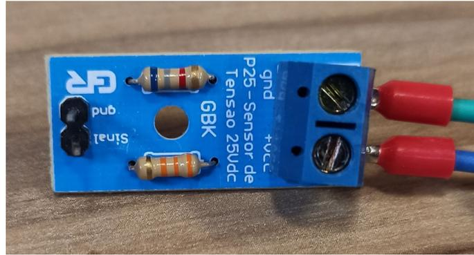
Figura 12 – Placa de sensor P25 utilizada.
