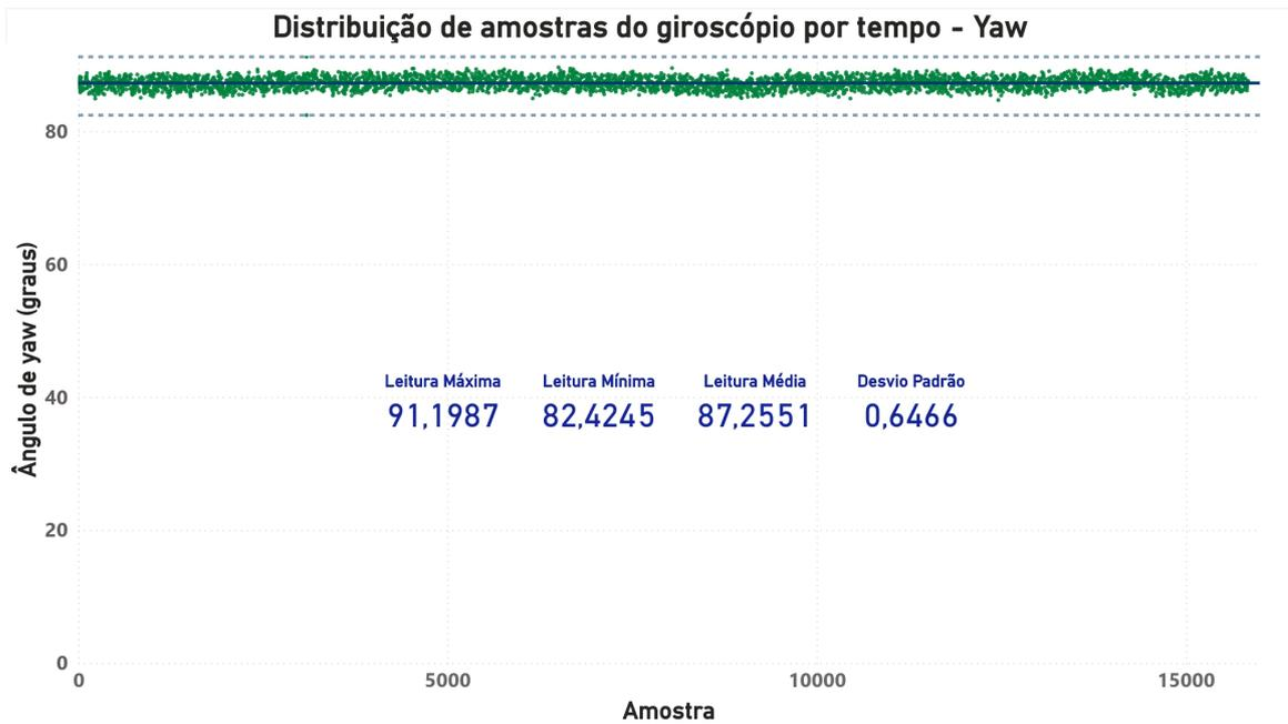
Figura 46 – Distribuição das amostras do ângulo de yaw no giroscópio.
