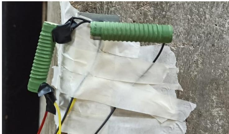
Figura 32 – Resistores em série utilizados nos testes.
