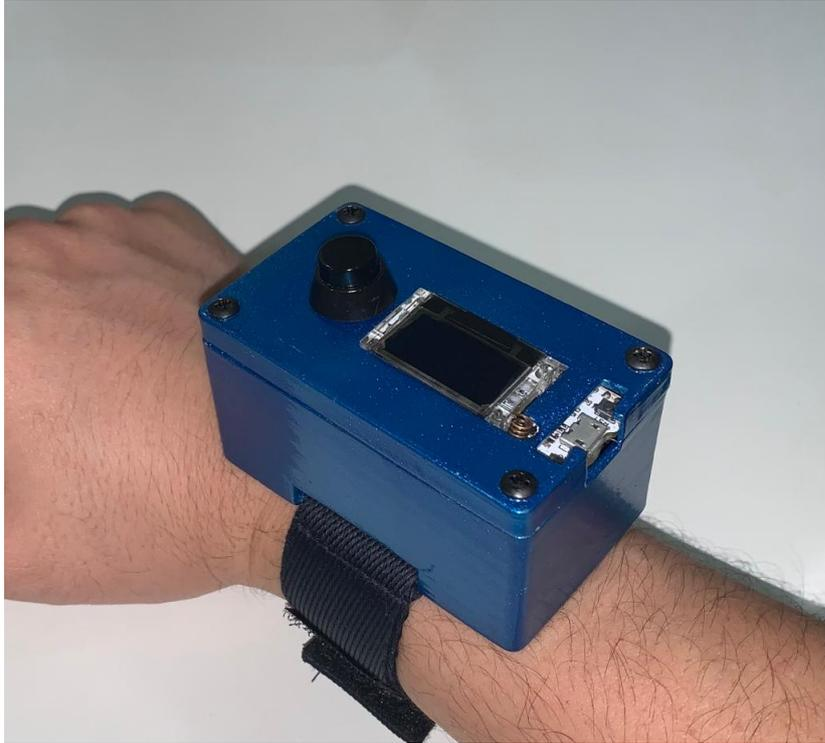
Figura 14 – Pulseira de Medição de Frequência de Tremores Finalizada.
