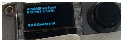
Figura 32 – Leitura da Pulseira para o Eixo Z.
