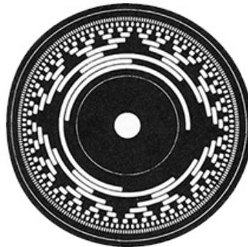
Figura 5 – Visualização interna de um encoder absoluto
