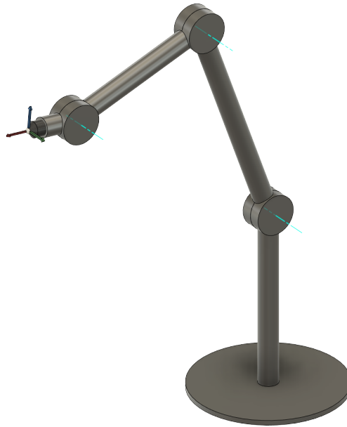
Figura 57 – Cadeia cinemática restrita às juntas A, B e D (eixos de rotação paralelos).
