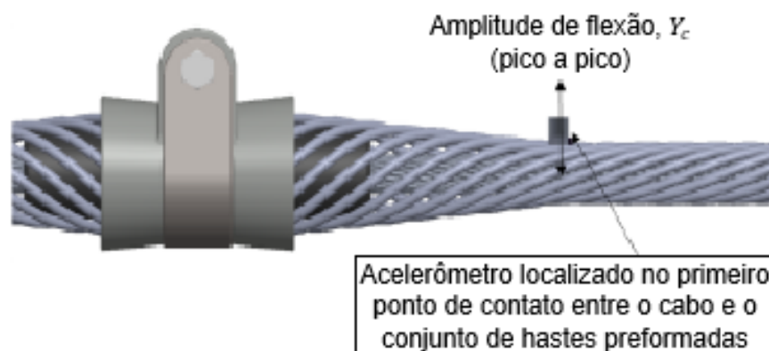
Figura 3.11: Posicionamento do acelerômetro no grampo AGS (modificado de Miranda et al. (2021)).
