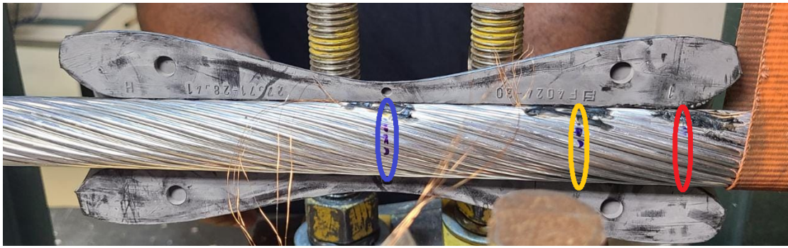
Figura 3.14: Início do posicionamento dos coxins elastoméricos com fixação dos extensômetros, conforme a Tabela 3.5.
