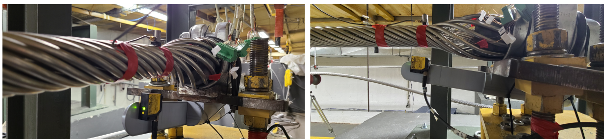
Figura 3.17: Montagem do medidor a laser e do acelerômetro.
