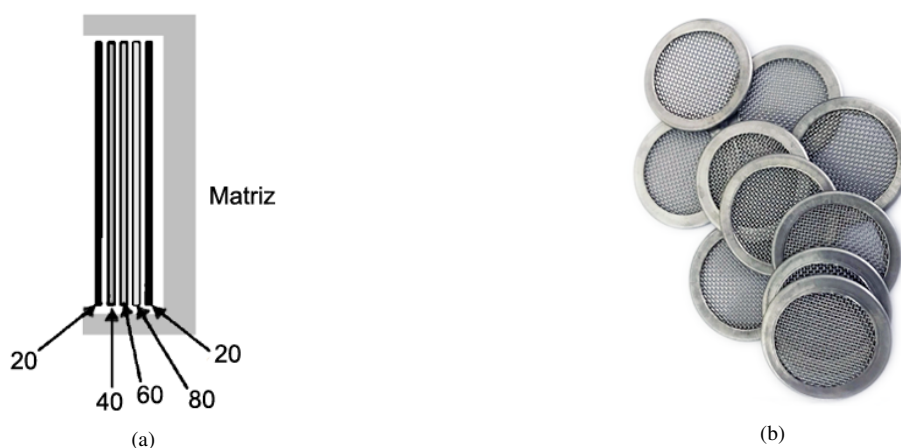
Figura 2.27: Conjunto de retenção de impurezas: (a) disposição de pacotes de telas e (b) pacotes de tela propriamente ditos.
