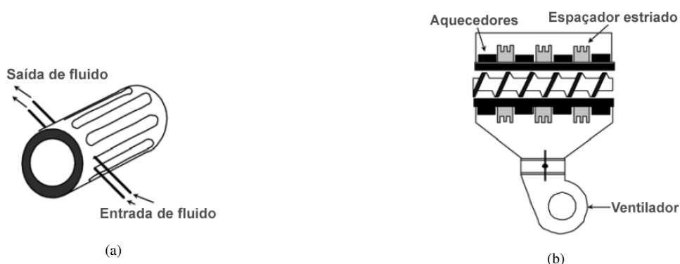
Figura 2.21: Exemplos de resfriamento (a) por fluido e (b) a ar.
