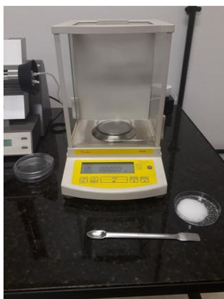
Figura 50 – Balança de precisão modelo AY220.
