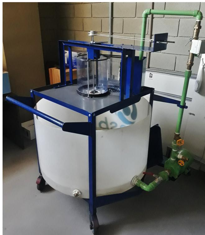
Figura 58 – Bancada de turbinas construída na Oficina da CAESB.
