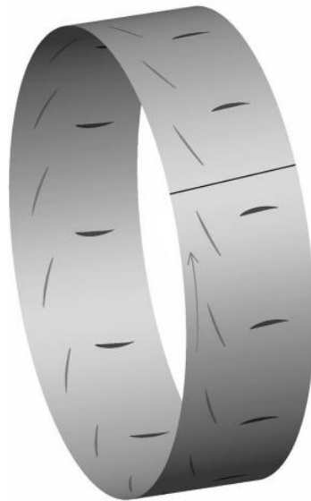
Figura 3.1 – Duto anular fino com 16 pás de rotor (cinza) e 13 pás de estator (preto) Fonte: (MISERDA; PIMENTA; ROCHA, 2020)
