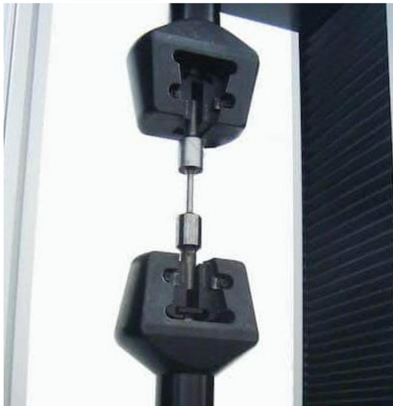
*Figura 1-1 - Ensaio de fadiga para estudo de propagação de trincas*
