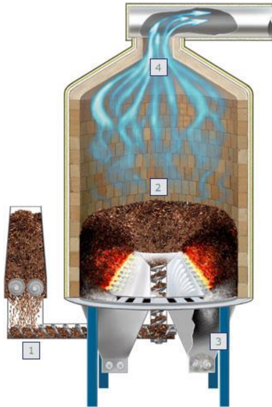
Figura 15- Fornalha para queima de biomassa com alimentador automático. (1) Alimentador; (2) Biomassa na câmara de combustão; (3) Bandeja de cinzas; (4) Gás aquecido devido à combustão.
