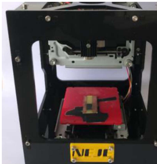
Figura 16. Dispositivo laser para gravação em madeira utilizado neste trabalho.
