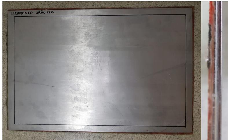
Figura 27 – Laminado metal-fibra com camadas metálicas lixadas manualmente, vista lateral à esquerda (autoria própria).
