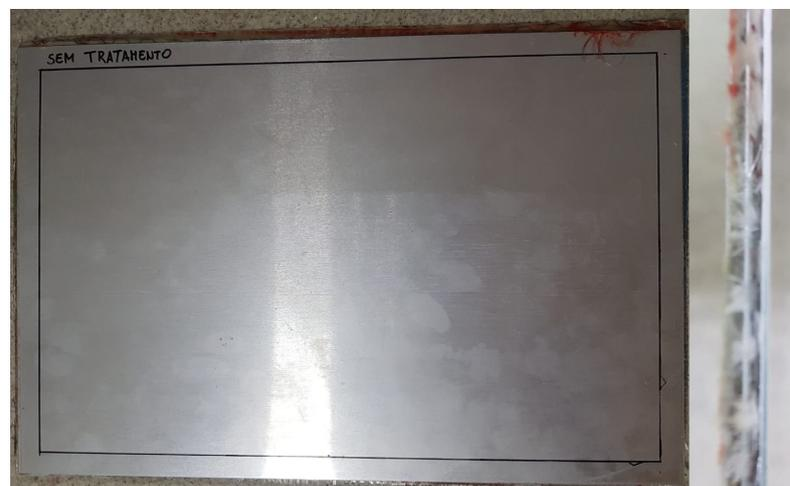
Figura 26 – Laminado metal-fibra sem tratamento das camadas metálicas, vista lateral à esquerda (autoria própria).
