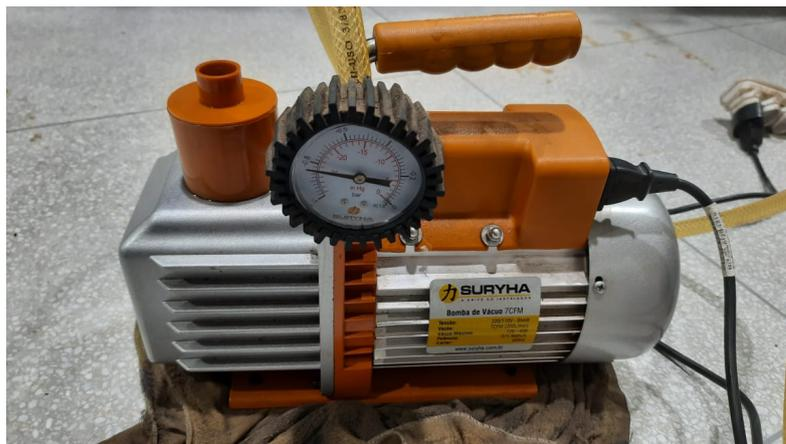
Figura 24 – Bomba de vácuo Suryha 7CFM (autoria própria).
