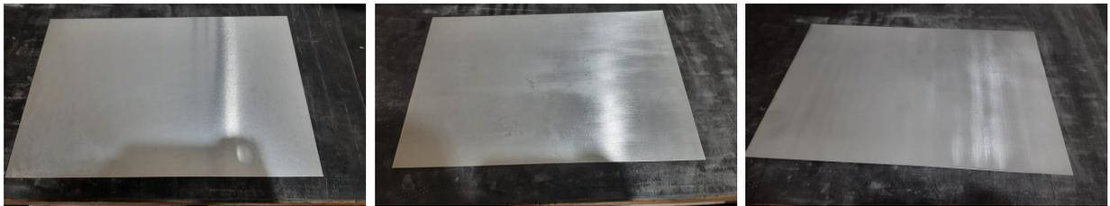
(a) Chapa sem lixamento (b) Chapa após lixamento na direção de  $0^\circ$  (c) Chapa após lixamento na direção de  $90^\circ$
