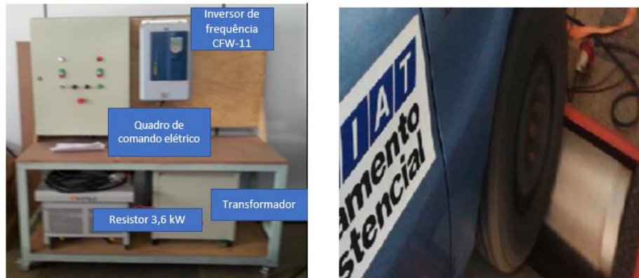
Figura 1 - Plataforma de ensaios de tração elétrica composta pela bancada de ensaios e o dinamômetro, respectivamente.
