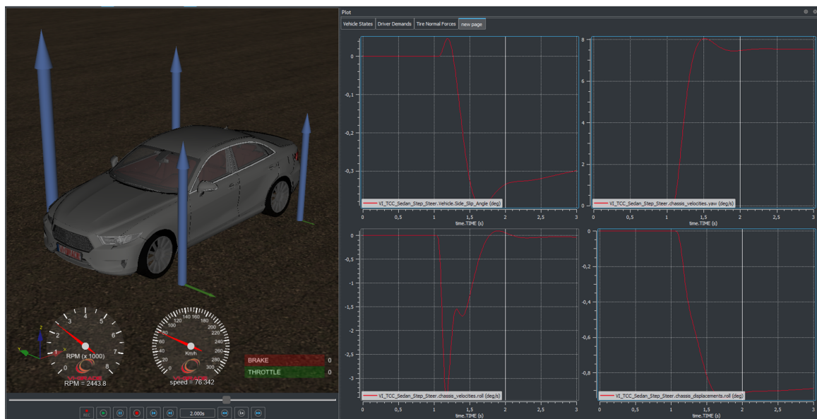
Figura 24 – Pós processamento de simulação do VI-CarRealTime para o esterçamento degrau com apresentação dos gráficos de variáveis de estado.
