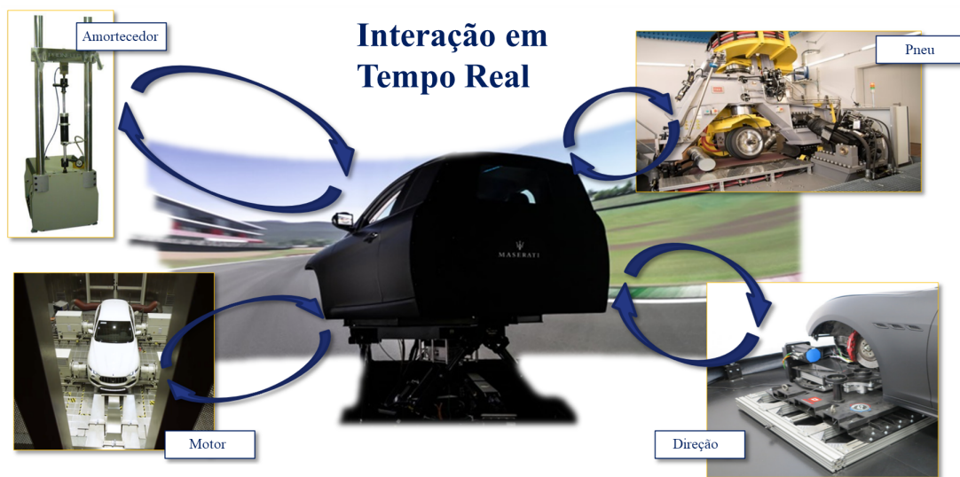
Figura 3 – Nova concepção hardware-in-the-loop no desenvolvimento da dinâmica veicular (Adaptado de Boreanaz (2021)).
