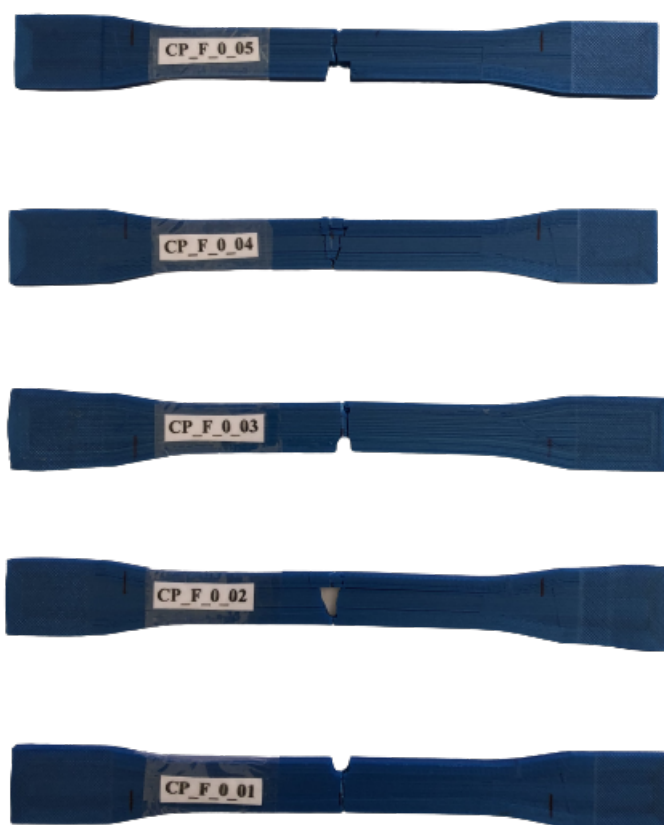
Figura 25 – Espécimes construídos na orientação Flat após o ensaio à tração.
