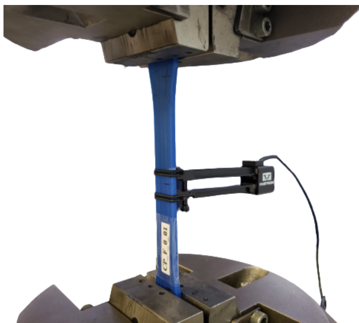
Figura 16 – Posicionamento do corpo de prova na máquina de teste para ensaio à tração.
