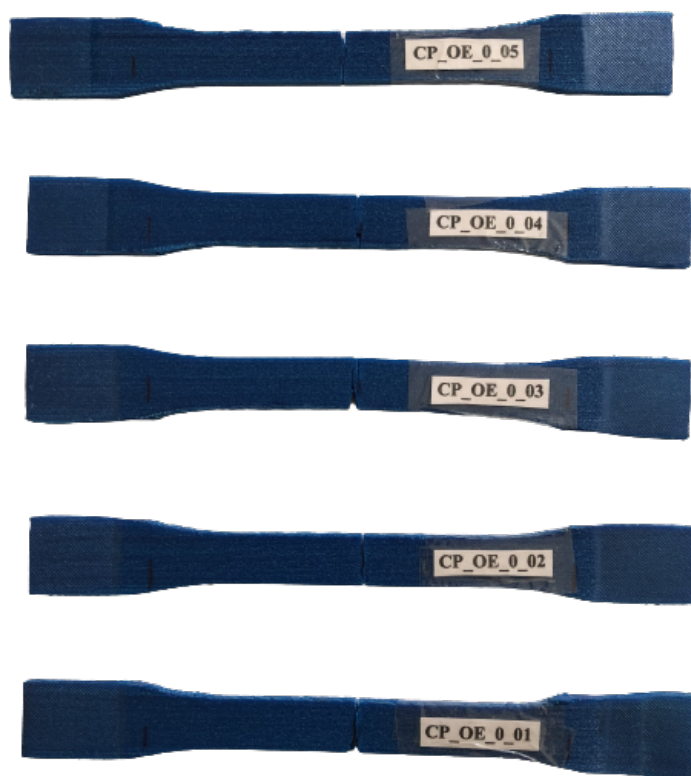
Figura 26 – Espécimes construídos na orientação On-edge após o ensaio à tração.
