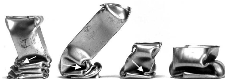
Figura 10 – Flexão global de tubos de seção quadrada a partir do desenvolvimento de modos simétricos de colapso. Fonte: Abramowicz (2003).
