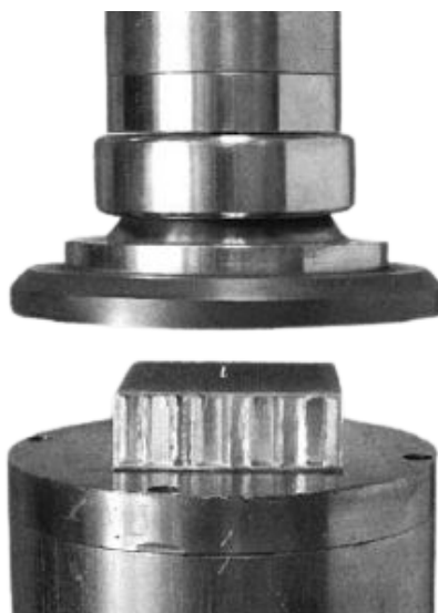
Figura 17 – Representação do esquema de montagem para o ensaio à compressão. Fonte: ASTM C365/C365M-16 (2016).
