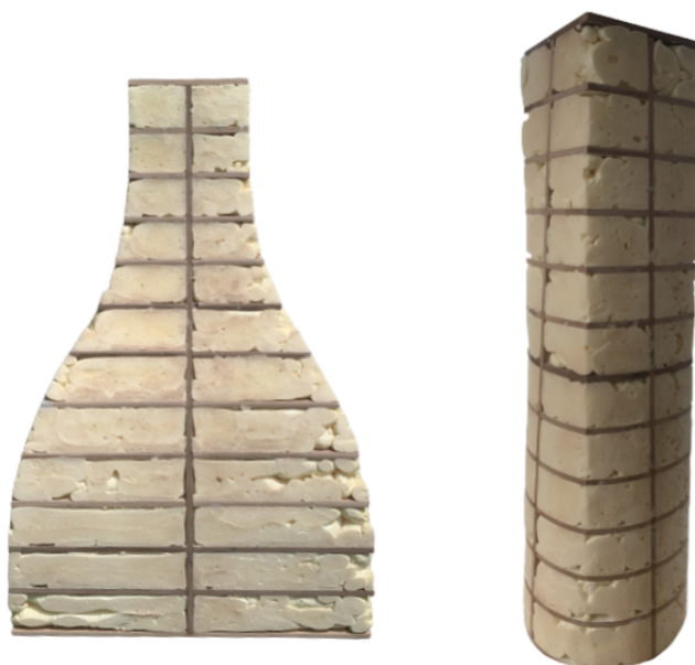
Figura 12 – Moldes com espuma de poliuretano
