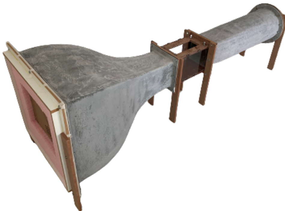
Figura 23 – Túnel de vento.
