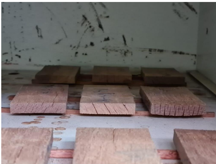
Figura 10. Defeitos na secagem da espécie jarana-amarela no interior da estufa.
