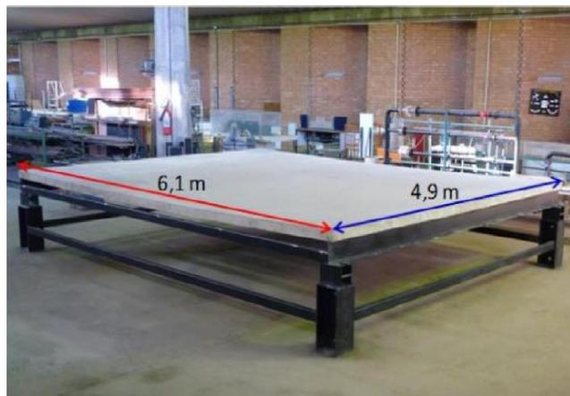
Figura 3.7 - Laje utilizada na validação do sistema (CARMONA *et. al.*, 2017)
