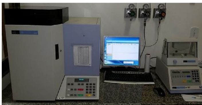
Figura 3.6: Analisador elementar CHNS da marca Perkin Elmer modelo EA 2400 serie II, localizado na Central Analítica do Instituto de Químicas da UnB (CAIQ).
