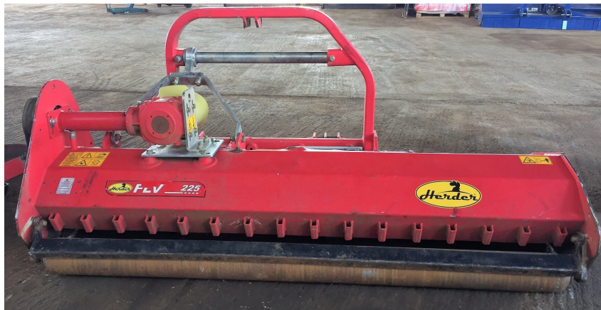
Figura 2.7: Roçadeira do tipo Flail Mower utilizando acionamento por TDP. Marca Herder, modelo FLV 225. [Fonte: (PEREIRA; ARAÚJO, 2018)].
