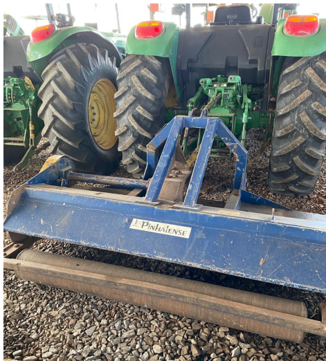
Figura 1.1: Roçadeira montada na parte traseira do trator utilizada pela empresa EBF. [Fonte: O autor].
