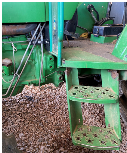
Figura 3.3: Escada utilizada pelo operador para ter acesso à cabine. [Fonte: O autor].
