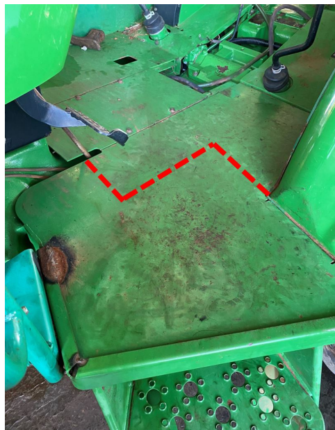
Figura 3.7: Corte a ser realizado no assoalho para eliminar a interferência com a estrutura projetada. [Fonte: O autor].
