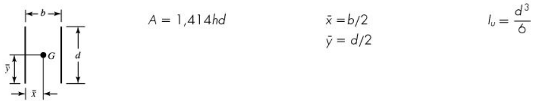
Figura 3.45: Especificações da geometria do cordão de solda para juntas em flexão. [Fonte: (BUDYNAS; NISBETT, 2011)].
