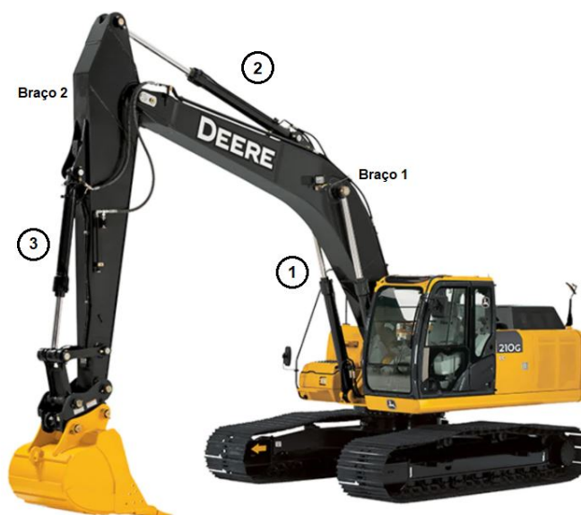
Figura 2.11: Ilustração de escavadeira com indicação dos cilindros hidráulicos. [Fonte: Adaptado de (DEERE, 2020)].
