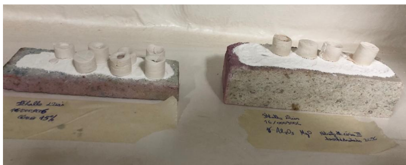
Figura 23: Amostras A-15 e A-20, segundo sua identificação, solidificadas dispostas sobre suporte cerâmico coberto com alumina
