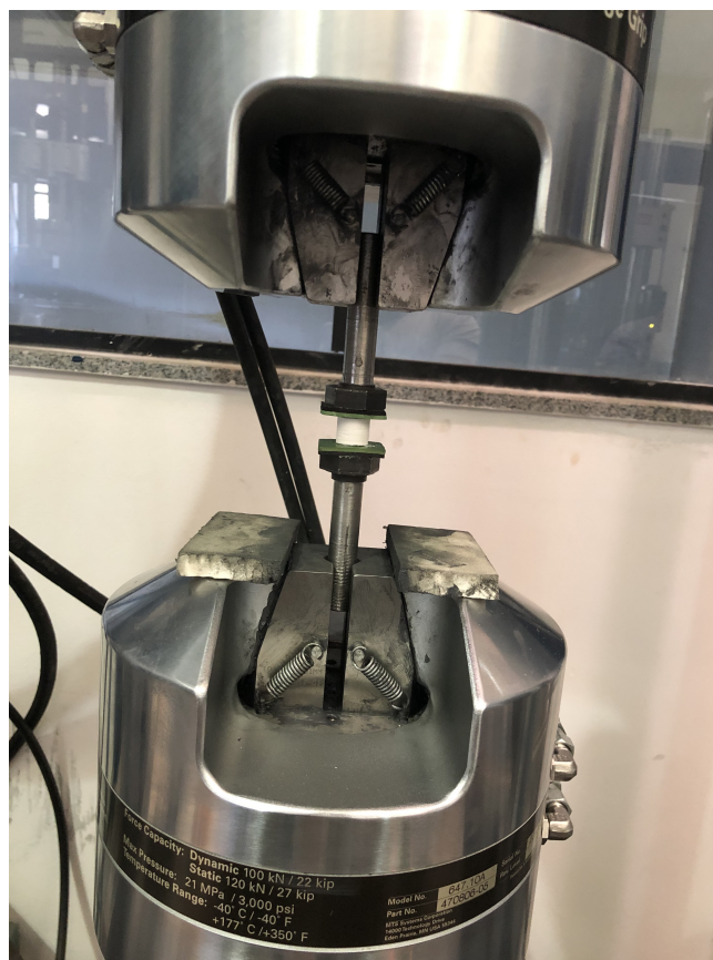
Figura 25: Equipamento utilizado para realização dos ensaios mecânicos de resistência à compressão
