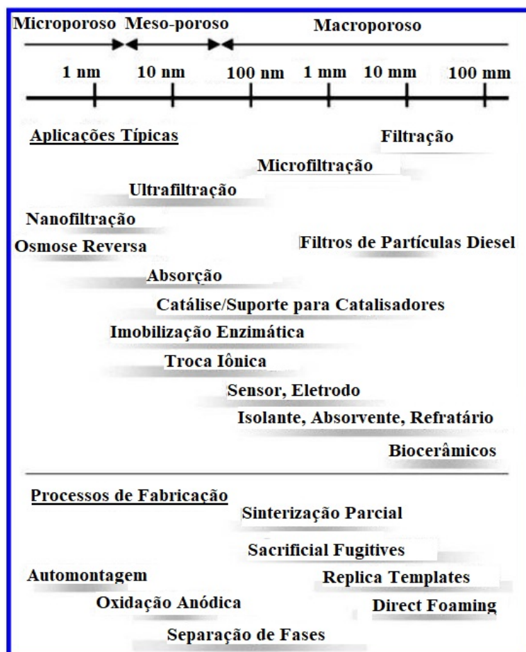
Figura 1: Classificação de materiais porosos quanto ao tamanho dos poros, além de processos de fabricação e aplicações típicas correspondentes
