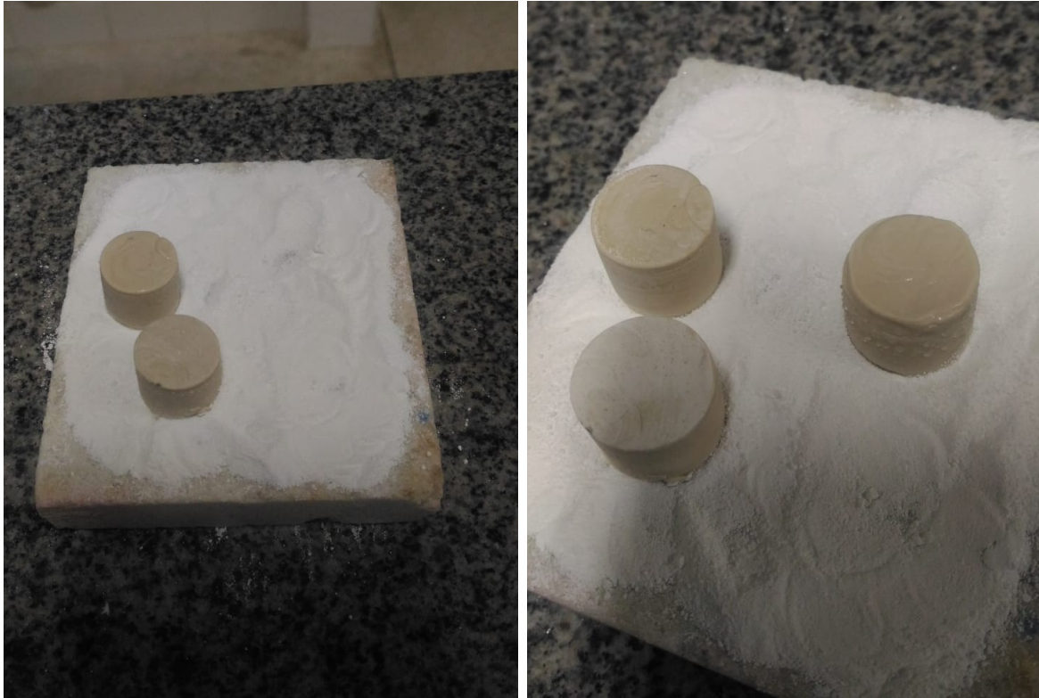
Figura 22: Amostras A-10 solidificadas dispostas sobre suporte cerâmico coberto com alumina
