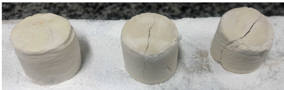
Figura 28: Amostras A-10 trincadas
