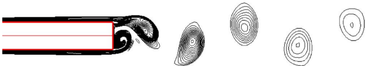
Figura 35 – Contornos da magnitude da vorticidade em tU_\infty/D = 262,5 para a região do bordo de fuga da lâmina isolada (Leclercq e Doolan, 2009).
