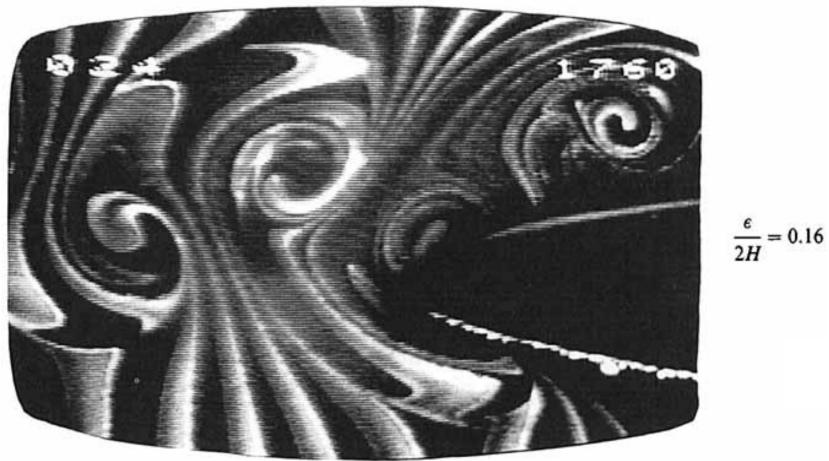
Figura 28 – Interação de uma esteira de vórtices em grande escala ( \epsilon/2H = 0,16 ) (Gursul e Rockwell, 1990).
