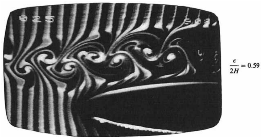
Figura 26 – Interação de uma esteira de vórtices em pequena escala ( \epsilon/2H = 0,59 ) (Gursul e Rockwell, 1990).
