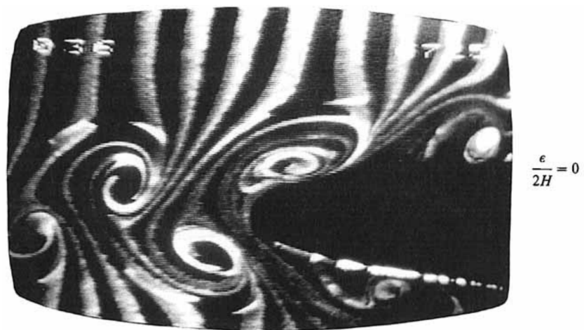
Figura 27 – Interação de uma esteira de vórtices em grande escala ( \epsilon/2H = 0 ) (Gursul e Rockwell, 1990).
