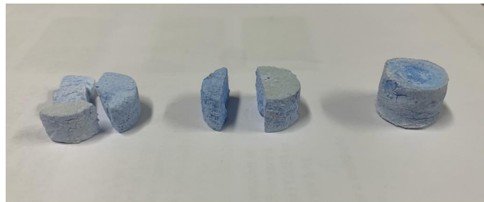
Figura 46: Amostras com concentração de 1%, 3% e 5% de nitrato de cobalto II, respectivamente, fraturadas após o ensaio de compressão.
