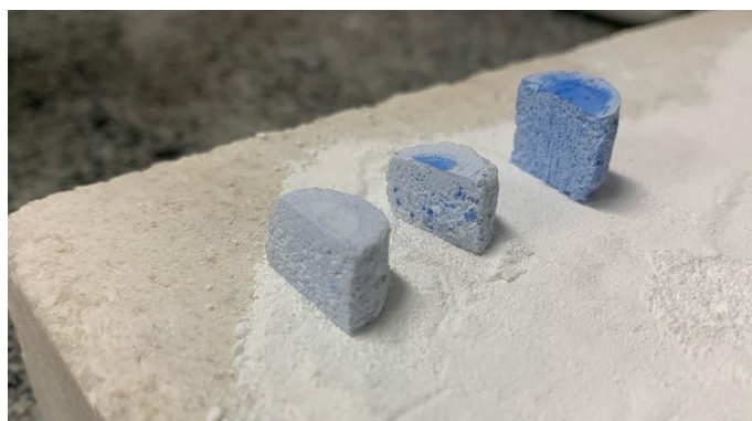
Figura 31: Amostras pós clivagem para microscopia.
