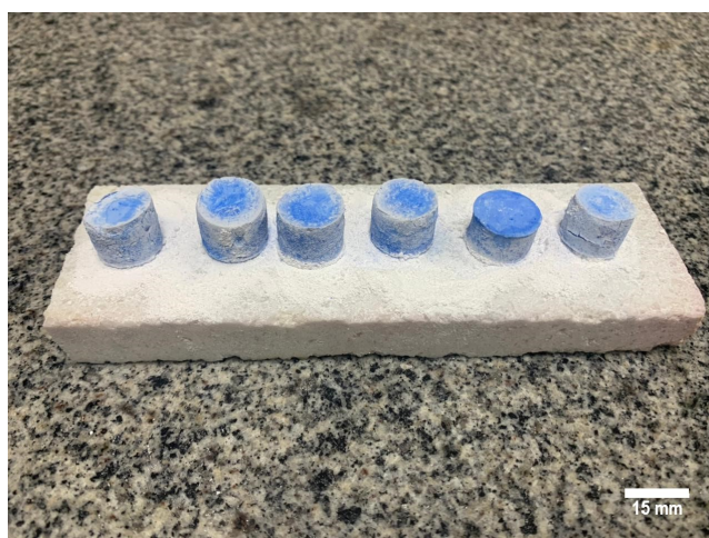
Figura 30: Amostras produzidas de alumina alfa dopadas com concentração de 5% de nitrato de cobalto II.
