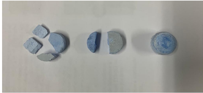
Figura 47: Amostras com concentração de 1%, 3% e 5% de nitrato de cobalto II, respectivamente, fraturadas após o ensaio de compressão.
