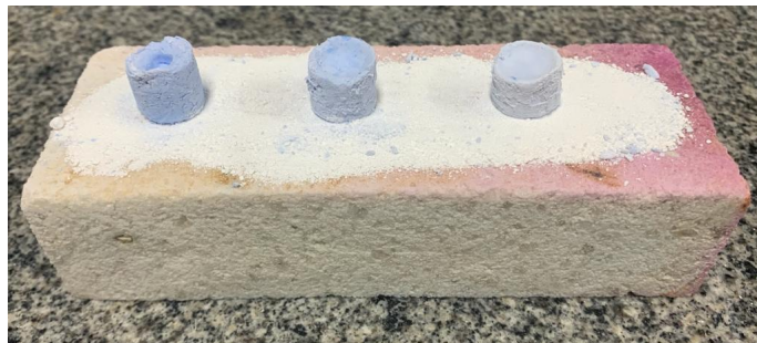
Figura 34: Coloração das amostras com concentração de 3% de nitrato de cobalto II depois da sinterização.
