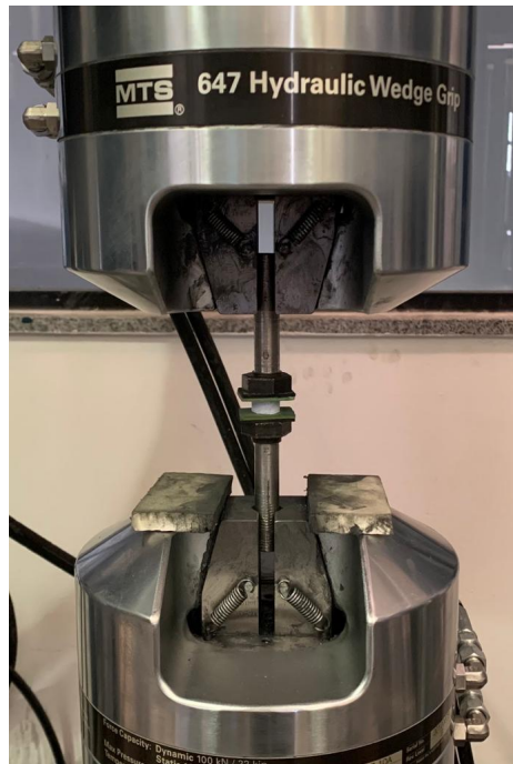
Figura 32: Equipamento utilizado para realização dos ensaios mecânicos de resistência à compressão.
