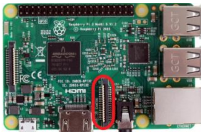
Figura 13 – Interface Serial Integrada destacada em vermelho (FOUNDATION, 2021)
