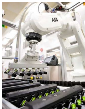
Figura 2: Robô ABB IRB 120 com efetuador terminal de copos de sucção em uma linha de produção da Loreal(CARDWELL; BELANGER, 2020)
