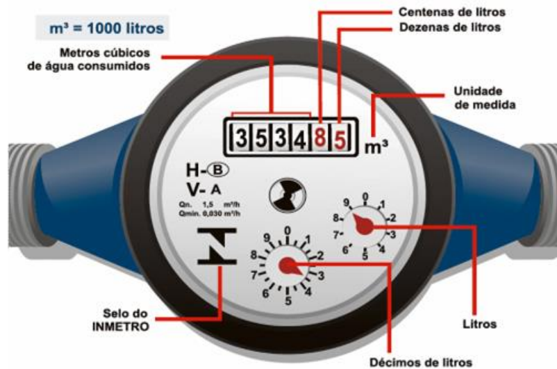
Figura 3.8 Hidrômetro velocimétrico
