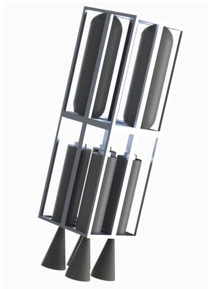
Figura 2 – Sistema de propulsão integrado com a estrutura do micro satélite.
