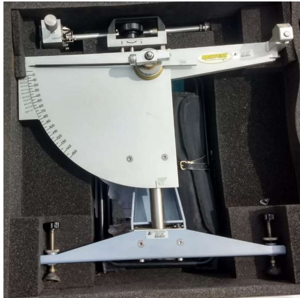
Figura 3.2- Equipamento de Pêndulo Britânico utilizado
