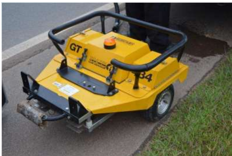
Figura 2.6- Equipamento para a realização do ensaio de Grip Tester
