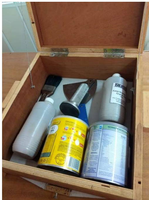
Figura 3.3- Conjunto de equipamentos de mancha de areia utilizados
