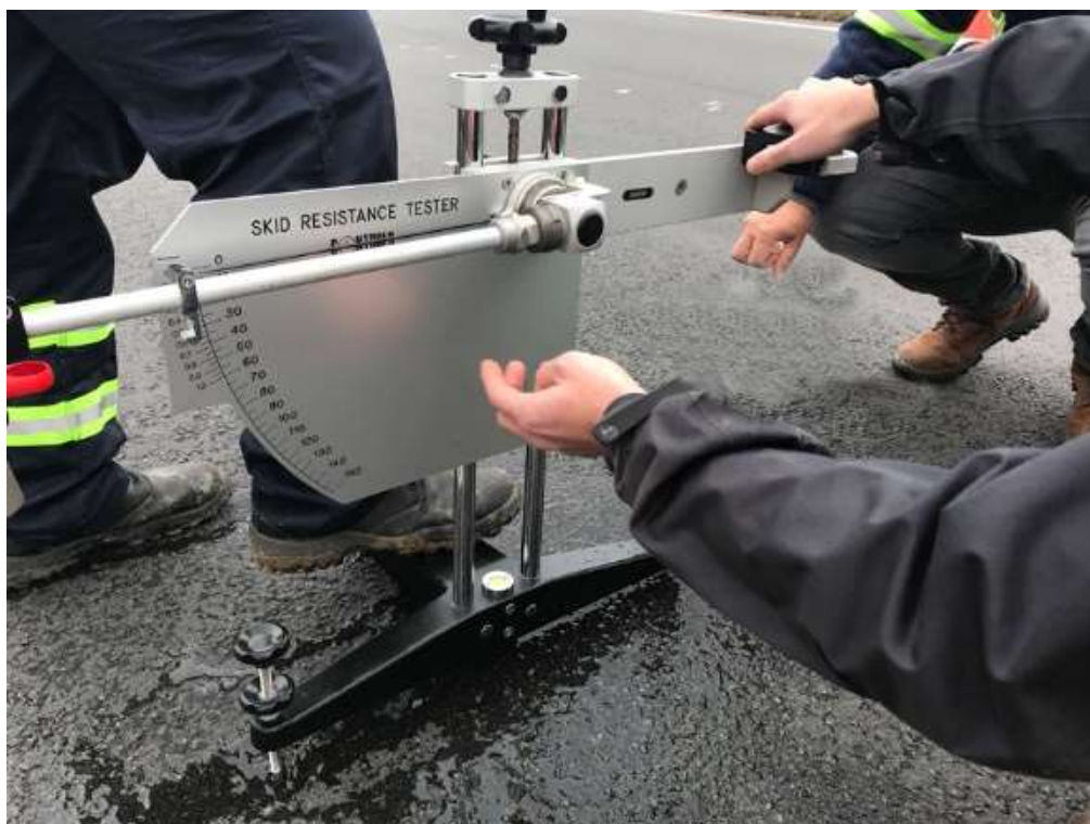
Figura 2.5- Realização do ensaio de pêndulo britânico
