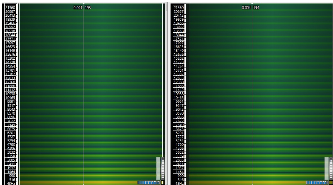
Figura 4.10: Espectrogramas das saídas esperada e obtida quadradas do ART1 de 130 neurônios.
