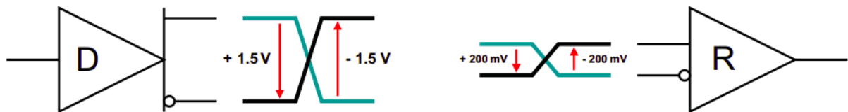
Figura 2.22: Especificação de nível de sinal para transmissão RS-485 (INSTRUMENTS, 2016).
