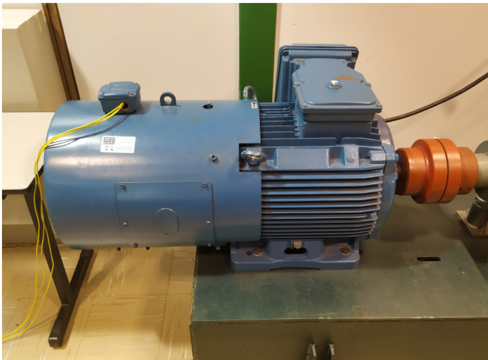
Figura 3.1: Motor de indução trifásico e ventilador (MENEZES; SATO, 2019).
