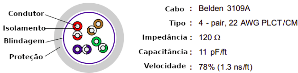
Figura 2.23: Modelo de cabo de comunicação RS-485, juntamente com suas especificações (INSTRUMENTS, 2016).
